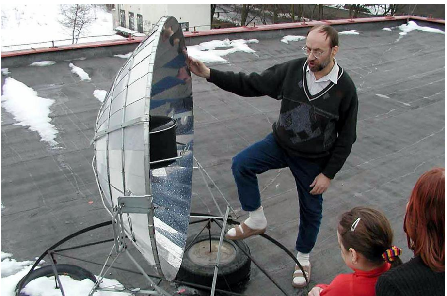
Šéf střediska předvádí solární sporák (to černé uvnitř je hrnec)
